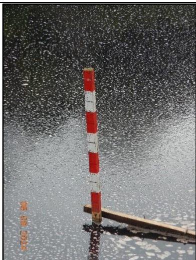
Fotografía 1. Fecha: 06.09.2024. Coordenadas UTM DATUM WGS84 18S Norte: 5.572.603. Este: 659.122. Descripción del medio de prueba: regleta que marca aproximadamente 176 centímetros del nivel del espejo de lixiviados.
